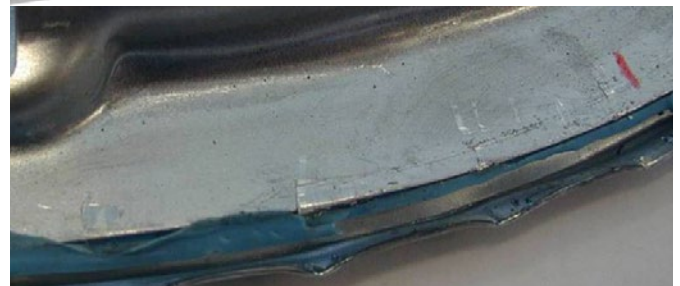
Blick ins Innere einer präparierten Autotür. Mit Neutronen sind kleinste Fehler in der Verklebung sichtbar.
