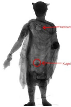
Mit der Neutronenradiografie (rechts) sieht man die Gusstechnik einer antiken Statuette des Gottes Merkur.
