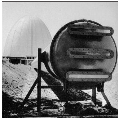
Das Endfenster des Schwerkraftrefraktometers (Strahlrohr F2)
